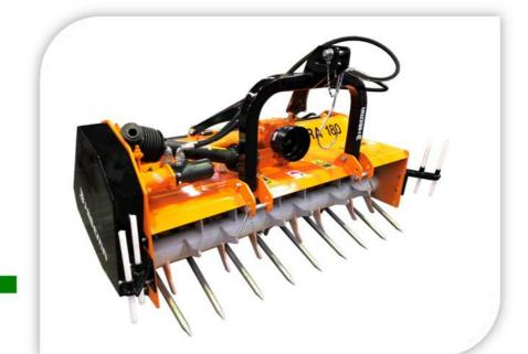
Trituradora con alimentador recogida y triturado Restos de poda, viña, olivo y almendro Transmisión martillos toma de fuerza rueda libre Trasmisión alimentador motor hidráulico
